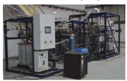
IMPIANTO PER LA PRODUZIONE DI 2  $\rm Nm^3/h$  di  $\rm H_2$  da Biogas con reattori dotati di membrane a base di Palladio
